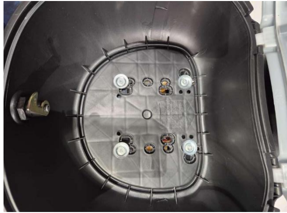
Aseta boksi pakalleen. Pujota kiinnityspultit prikkujen kanssa rungon kiinnitysreikien läpi.
